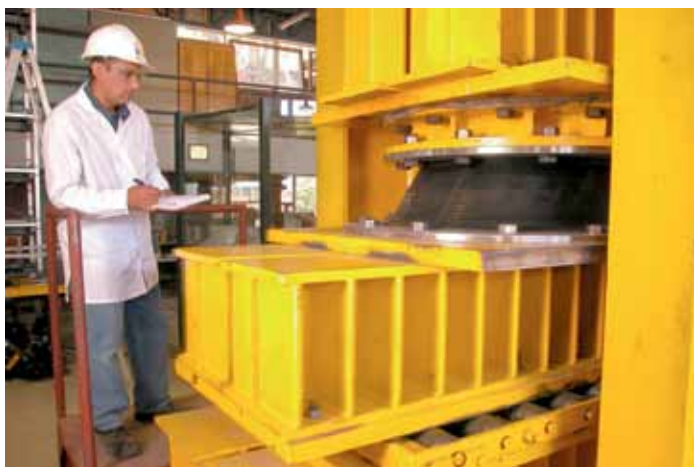
Ejemplo de ensayo de un aislador sísmico en laboratorio de Dictuc.
