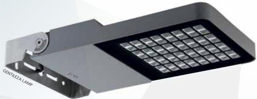
Línea NEOS, que consta de una caja de dos piezas de aleación de aluminio inyectado pintado. Asimismo, el cuerpo contiene el reflector de aluminio abrillantado y anodizado y una placa de auxiliares eléctricos desmontable.
