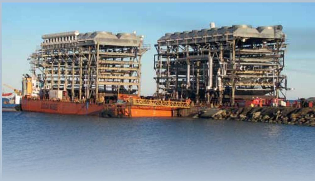
La particularidad del barco que realiza los traslados es que contiene dos pallets como parte de su plataforma de acopio que se sumergen hasta una profundidad adecuada para permitir que las barcasas naveguen al muelle y así sea más sencillo subir las estructuras a la nave.
