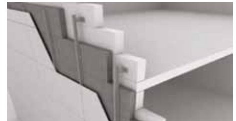
Aplicación tipo aislación interior
