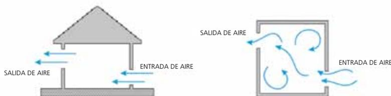
Esquema de ventilación cruzada en elevación y en planta. La entrada y salida de aire por las diagonales más largas de los recintos hace que el aire fluya por una mayor cantidad de lugares.
