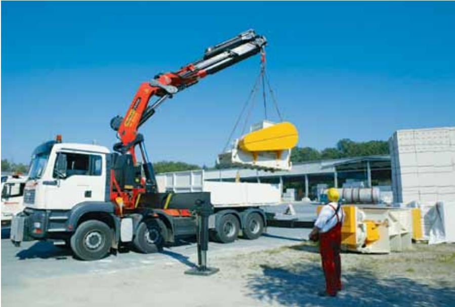
La grúa PK 85002 es la más potente del equipo de Palfinger. Ofrece un momento máximo de elevación de 71,7 m y un alcance de 25,5 m.
