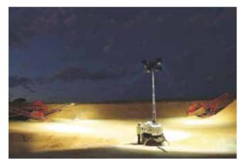
respecto al consumo energético, unos 150 W de gasto entregan un nivel de iluminación equivalente a una lámpara de haluro metálico de 400 W. Además, su vida útil es de 10 veces más que un foco de haluro metálico (70.000 versus 7.000 horas), son altamente resistentes a impactos y explosiones, no poseen balasto electrónico ni dispositivo de encendido, cuentan con lentes sólidos de policarbonato, sus focos no requieren ser remplazados, y tienen un sistema de reinicio en caliente.
