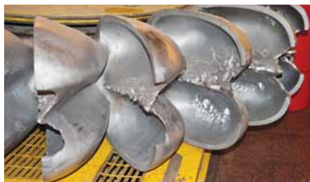
Deterioro de las aspas de la turbina debido al paso del agua durante una temporada completa.
