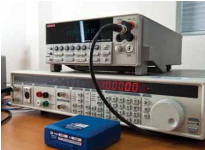
El equipamiento del nuevo laboratorio de acústica del ISP, incluye básicamente un equipo generador de señal, multímetro y pc con software de calibración.
