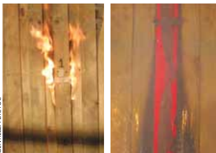
FIGURA 1. Vista una probeta con perfilería metálica y revestimiento tinglado donde se aprecia la falla y la deformación del montante metálico.
