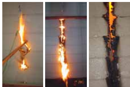
FIGURA 2. Vista de una probeta con perfilería metálica y revestimiento smart panel donde se aprecia la falla y la coincidencia de ésta con el montante metálico.
