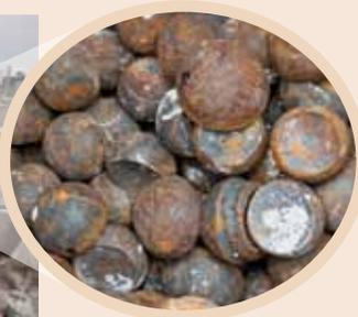
Por dentro, el cajón de hormigón se rellena con esferas de acero de entre 7 y 10 cm de diámetro, aproximadamente. Para evitar los vacíos dentro de la masa y aprovechar al máximo los espacios, a medida que se introducen las esferas, se rellena con lechada. Terminando con una capa de ésta, para sellarlo. Este sistema permite optimizar los espacios, generando masas de mayor densidad, obteniendo así un mayor peso a través del relleno de los cajones.
