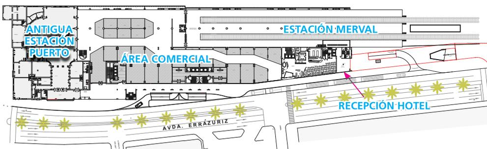
**Arriba.** En la planta de la cubierta del proyecto puede observarse de izquierda a derecha la Antigua Estación Puerto, el edificio de oficinas con sus entrantes para aumentar el perímetro de fachada, y el hotel.
