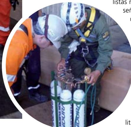
Sistema utilizado para el suministro de una mezcla enriquecida con oxígeno que se dispuso en el interior de la Cápsula Fénix 2.
