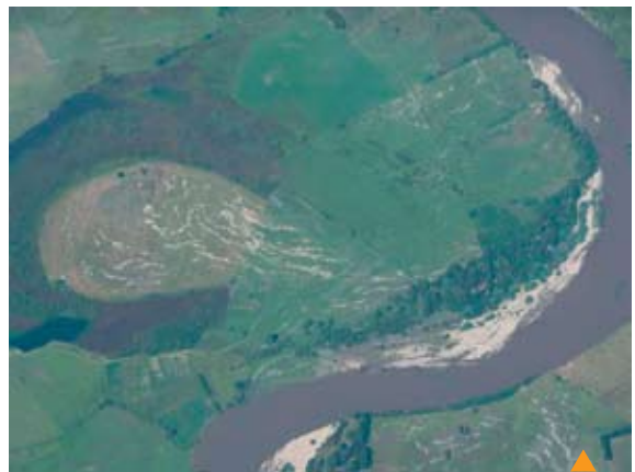
En el río Carampangue se observa la manifestación de licuefacción del suelo superficial desde más de 1.000 m de altura.
