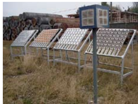
Tras los bastidores de la estación de Valdivia pueden verse elementos metálicos con un alto grado de corrosión.
