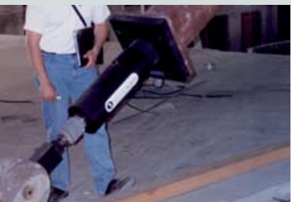
7. Disipadores de energía
