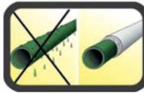
**5** Para evitar la condensación en usos al exterior, se debe aislar la tubería.
