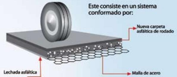
Este sistema consiste en el refuerzo de los pavimentos en mal estado, con una malla de alambre de acero con cables de refuerzo, que se adhiere al camino con slurry seal y luego, se cubre con una nueva carpeta de rodado de asfalto.
