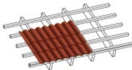
La instalación de la teja de hormigón colonial se hace sobre costanera de pino de 2 x 2" para separaciones normales de cerchas o tijaerales de 0,9 metros.
