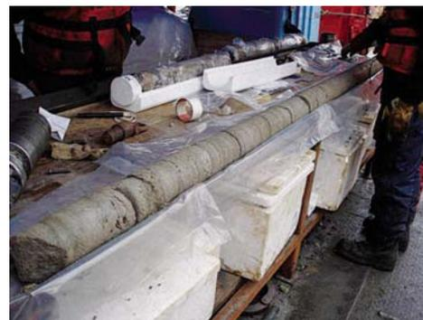
Novedosos sistemas de sondaje permiten la obtención de muestras de 10 cm de diámetro, más completas que las tradicionales que alcanzan sólo 6 centímetros.
