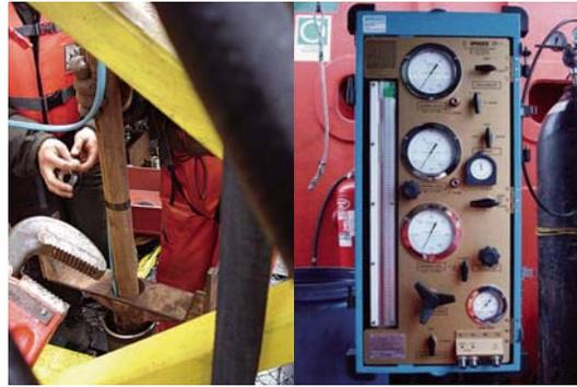
Los Ensayos Presiométricos consisten en la dilatación por gas a presión de una celda cilíndrica contra las paredes del sondeo.
