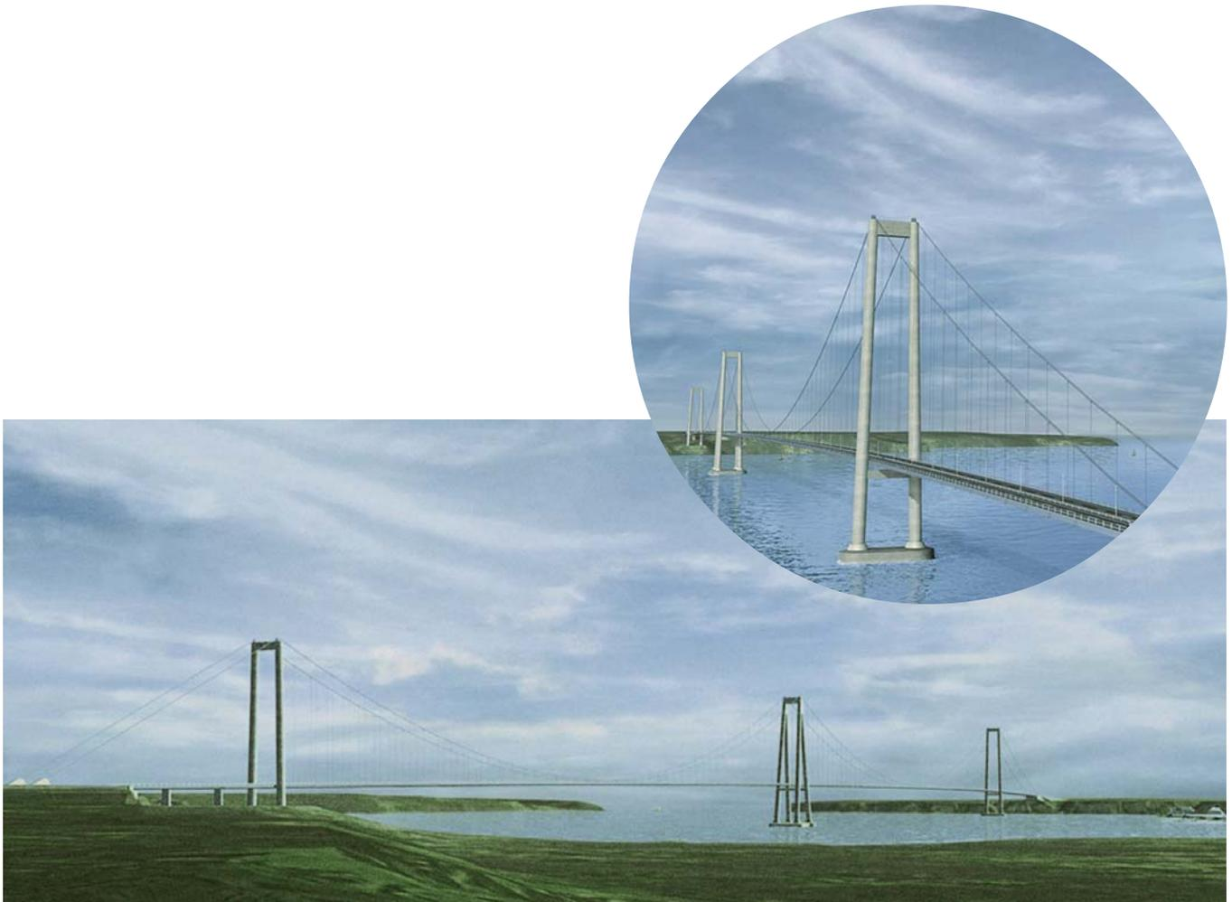
Imagen virtual del diseño del Puente Bicentenario de Chiloé. En el centro se ubica la pila central en forma de A, instalada sobre la Roca Remolinos. Arriba se observa la pila norte en primer plano.
