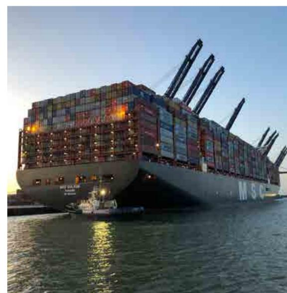
MSC Gülsün fue construido en el astillero Samsung Heavy Industries (SHI) Geoje en Corea del Sur y tiene 400 metros de largo y 60 metros de ancho, para alcanzar una capacidad de 23.756 TEU. Lanzado en Agosto 2019
