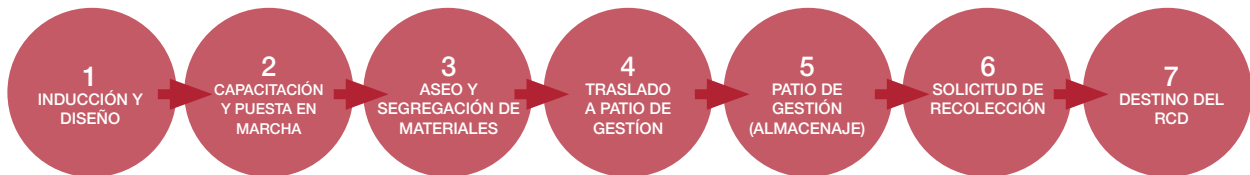
FIGURA 2. ETAPAS PARA EL DISEÑO DE UN PLAN PARA LA GESTIÓN DE RCD EN OBRA
