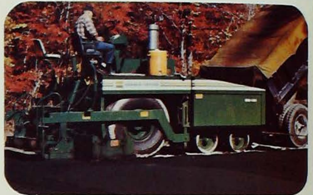
BARBER-GREENE Asfaltadoras Portátiles, con control automático de nivelación transversal y longitudinal y de perfecta operación en la pavimentación de curvas.
