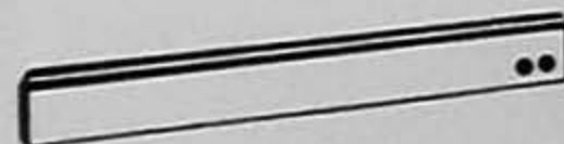
Calefacción por convección adosado en zócalo de pared controlada por termostato.
