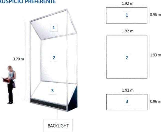
\* Las estructuras serán construidas en sistema modular de aluminio y los soportes para la gráfica serán de policarbonato alveolar. La gráfica será impresa en PVC autoadhesivo.
