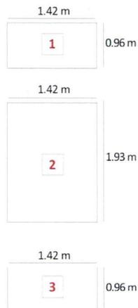
\* Las estructuras serán construidas en sistema modular de aluminio y los soportes para la gráfica serán de policarbonato alveolar. La gráfica será impresa en PVC autoadhesivo.
