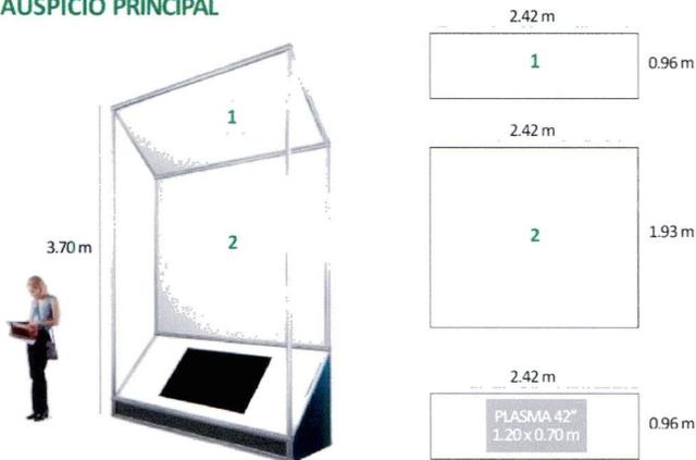
\* Las estructuras serán construidas en sistema modular de aluminio y los soportes para la gráfica serán de policarbonato alveolar. La gráfica será impresa en PVC autoadhesivo.
