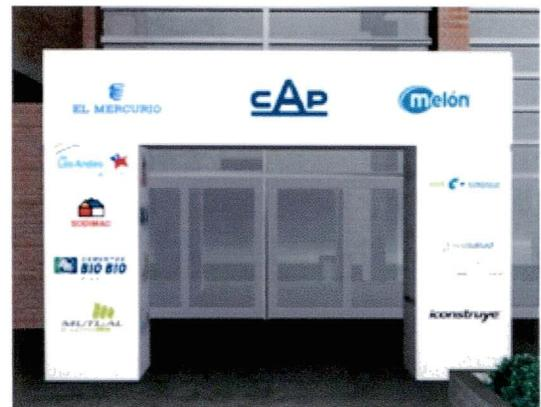
1 Estructura en perfiles de hierro, cubierta mdf 5 mm, terminación blanca.
