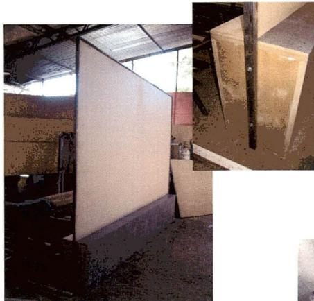
Se presentó panel con corrección para el problema de estabilidad por medio de perfilera metálica enmarcando la estructura, de resultado óptimo.
