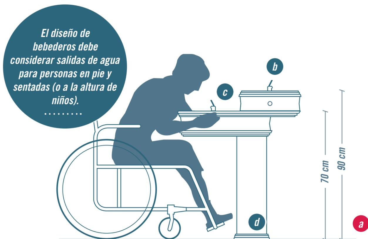
**a.** Los desagües deben estar al mismo nivel del pavimento, en caso de contar con barras o rejillas no podrán tener separaciones mayores a 1,5 cm entre sí y deberán disponerse en forma perpendicular al sentido del flujo peatonal. / **b.** La llave de apertura y cierre deberá ser de presión, palanca o de fácil operación. / **c.** La toma de agua no debe estar a más de 40 cm del inicio del borde. / **d.** No emplear bebederos con pulsadores de pie.
