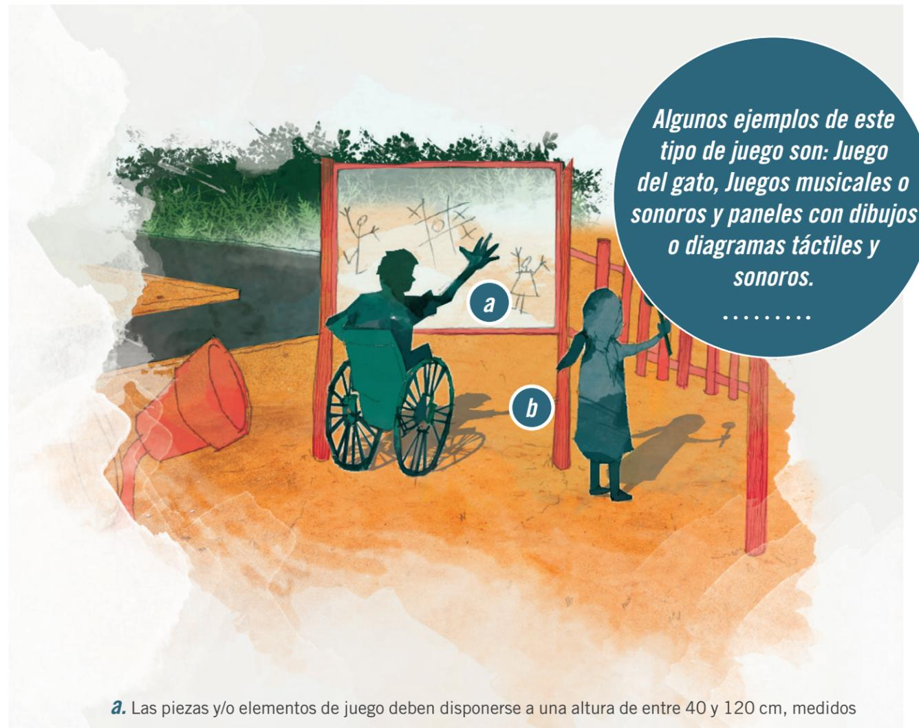
**a.** Las piezas y/o elementos de juego deben disponerse a una altura de entre 40 y 120 cm, medidos desde el nivel de piso terminado, y con una profundidad máxima de 40 cm para facilitar su agarre o accionamiento. / **b.** Espacio libre bajo la plataforma de juego de 40 cm.
