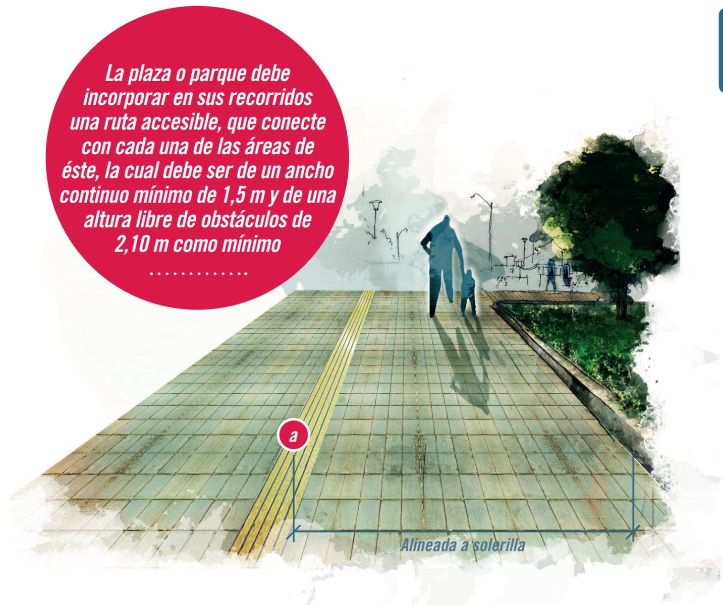
**a.** En circulaciones peatonales de ancho mayor a 3 m, la huella podotáctil va alineada con las solerillas que confían el pavimento de circulación
