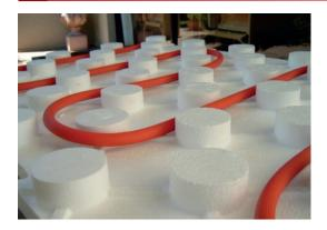
La instalación de las cañerías se realiza sólo por presión, lo cual reduce notoriamente el tiempo necesario para terminar la faena. La PLACA LOSA RADIANTE DE AISLAPOL® presenta además un diseño de ensamble lateral entre placas, lo cual asegura la continuidad de la capa de aislación térmica, evitando los puentes térmicos, además de facilitar el trabajo de instalación en terreno.
