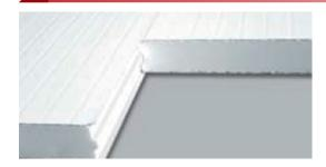
El PANEL RUDNEV® para la construcción se compone de un núcleo aislante de Poliestireno Expandido - aislapol® - de alta densidad (20 kg/m³), revestido por ambas caras con una lámina de acero galvanizado termo-esmaltado de color blanco.
