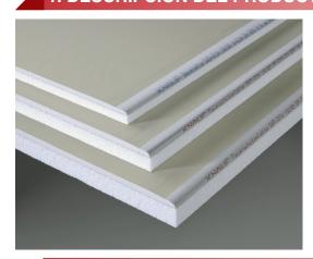
Knauf POLYPLAC® es un revestimiento térmico para muros perimetrales, conformado por la unión de una placa de yeso-cartón y una plancha de poliestireno expandido de densidad de 15kg/m³ de diferentes espesores según zona térmica. Se adhiere a muros interiores perimetrales de hormigón o albañilería para mejorar su aislamiento térmico..
