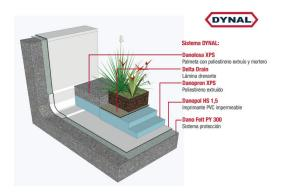
La disposición de la capa aislante sobre de la impermeabilización de la cubierta, es una solución innovadora que proporciona importantes ventajas técnicas tales como:
