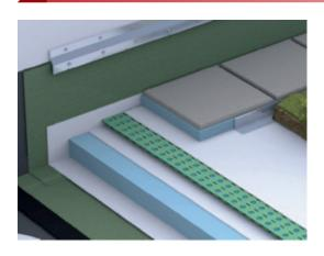
Los SISTEMAS DE CUBIERTAS INVERTIDAS, están compuestos por soluciones de impermeabilización, drenajes, capas separadores y aislación térmica de poliestireno extruido (XPS) en los cuales la aislación térmica queda por sobre la impermeabilización, resistiendo sin perder sus prestaciones, a la lluvia, heladas, to exteriores y otras cargas.
