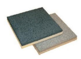
DANOLOSA, baldosa aislante constituida por un pavimento de hormigón poroso, que actúa como protección mecánica de una base aislante de poliestireno extruido (XPS), resultando una superficie practica, resistente y aislada térmicamente, apta para tránsito.
