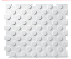
La PLACA LOSA RADIANTE se trata de un producto de Poliestireno Expandido (EPS) fabricado por moldeo y que presenta un diseño conformado por resaltes circulares ("nopas") repartidos en el total de la placa, lo que la hace adecuada para la distribución de cañerías de sistemas de calefacción (pisos radiantes) dejándolas fijas y ordenadas, sin necesidad de algún otro sistema de sujeción entre la cañería y la placa.
