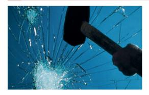
El CRISTAL LAMINADO BLINDEX SEGURIDAD se produce al unir dos o más láminas de Cristal Float con una o más interláminas plásticas de polivinil butiral (PVB), bajo calor y presión.
