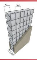
Covintec es un SISTEMA ESTRUCTURAL DE MUROS, de origen norteamericano, basado en paneles prefabricados de malla de acero galvanizado, tridimensional, electrosoldada. En su centro, el panel cuenta con un alma de poliestireno expandido de densidad mínima de 10 kg/m³ que se recubre por ambas caras con hormigón proyectado o vaciado entre moldajes para terminar el muro.
