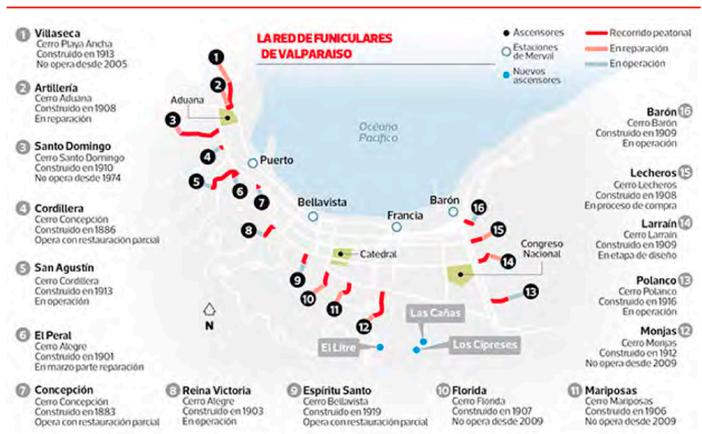
FIGURA 96 Condición de los distintos ascensores de Valparaíso
