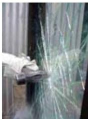
Dicha capacidad está comprobada mediante pruebas de impacto que se le realizan al producto. Una de ellas es mediante la Bola de Impacto.
