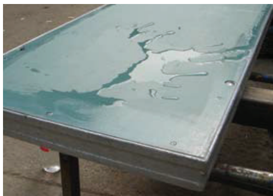
Moldajes en base a planchas plásticas reciclables provenientes de Asia. Alta impermeabilidad (DOM)
