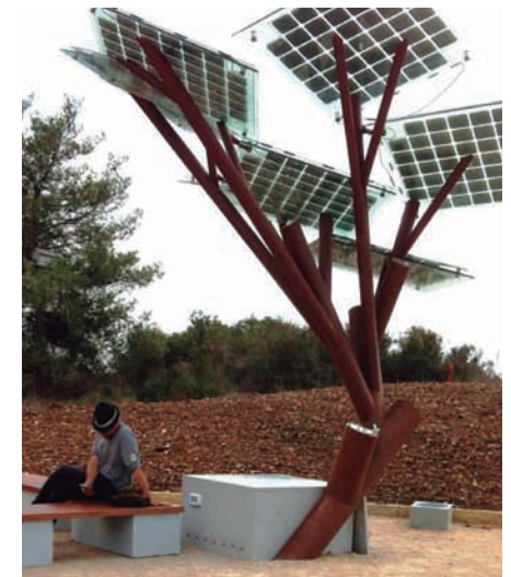
SOMBREADOR CON PANELES FOTOVOLTAICOS, ISRAEL
