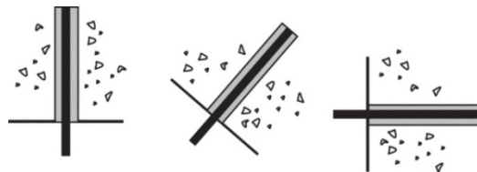
Fig. R2.2 — Posibles orientaciones de pernos de cabeza, horizontales e inclinados hacia arriba.
