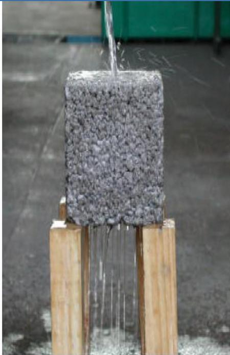
Hormigón permeable desarrollado en la Universidad Católica de Chile. Tiene una capacidad de infiltración mejor que la de la arena.
