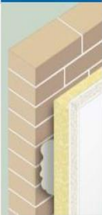
Aislación térmica de los muros
