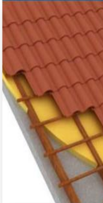
Aislación térmica de la techumbre
