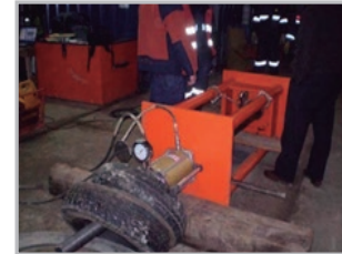
Ejecución del ensayo a tracción sobre la unión roscada macho-hembra, supervisado y verificado por IDIEM
