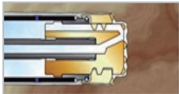
Paso 1: perforación con bit piloto y corona
