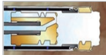
Paso 2: extracción de las barras y bit piloto
