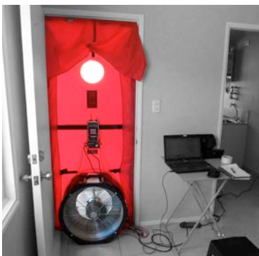
Figura 4.10: Equipo Q4E Blower Door Retrotec de un ventilador adecuado para medición de viviendas y edificios pequeños, disponible en laboratorio CITEC.
