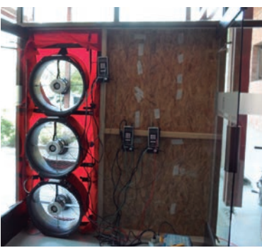
Figura 2.3: Equipo Model 3 Three Fan System Minneapolis instalado.
