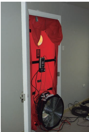
Figura 2.2: Equipo Standard Model 3 Minneapolis en funcionamiento.
