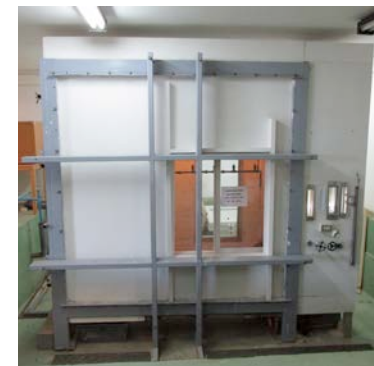
Figura 6.5: Cámara de infiltración del Laboratorio de Física de la Construcción de CITEC UBB con ventana instalada.
