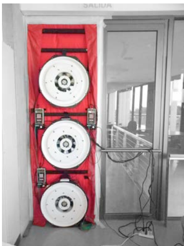
Figura 4.9: Equipo Model 3 Three Fan System Minneapolis de tres ventiladores, disponible en laboratorio CITEC.
