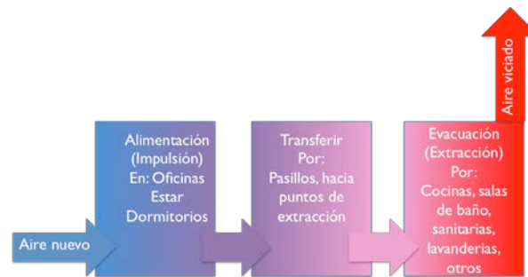
Figura 9.8: Esquema de circulación flujos de aire viviendas
