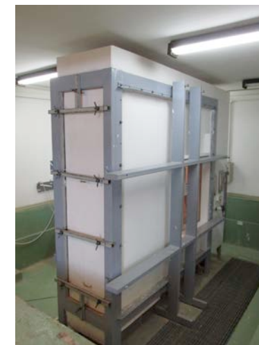
Figura 6.6: Vista lateral de la cámara de infiltración del Laboratorio de Física de la Construcción de CITEC UBB.
