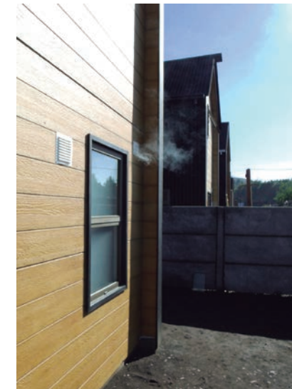
Figura 10.19: Visualización de flujos de aire con humo
