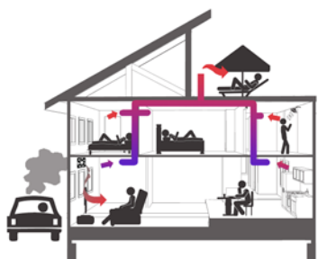
Figura 9.11: Incorrecta localización de admisión y extracción
