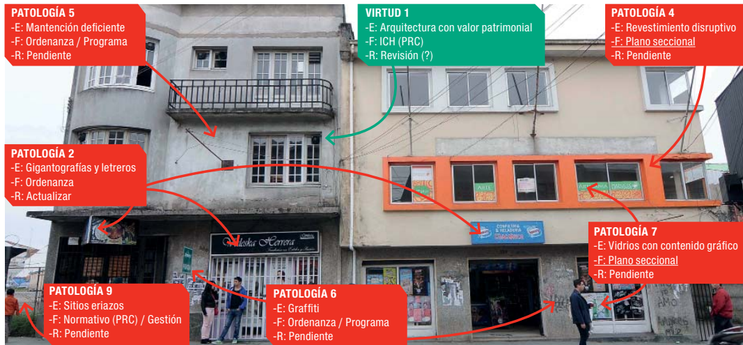
Imagen 17: Patologías y virtudes identificadas en tramo de la calle Chacabuco.
