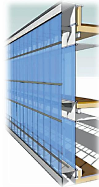
Figura 1.1. Sección Vertical de Muro Cortina.
