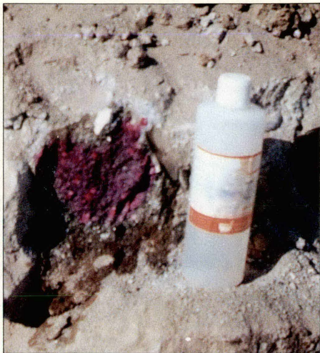
Foto 35 Cal no afectada por la humedad.
