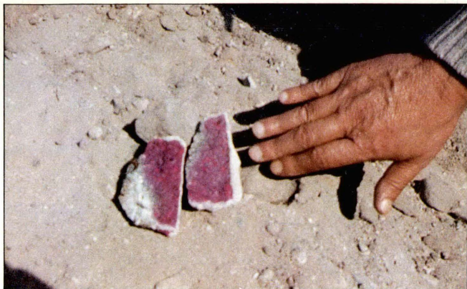
Foto 33 Solución química muestra la cal no afectada por la humedad.
