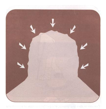
El riesgo de caída de planchones será mayor, mientras más descompuesta sea la roca en que se está trabajando, además dependerá fundamentalmente de la sección de la galería que se está desarrollando, del procedimiento que se esté usando para abrir la galería, y del tipo y cantidad de explosivo usado.
