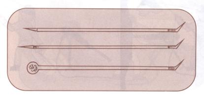
Hay operaciones en las que en reemplazo de la Barretilla de Seguridad, se usa una confeccionada con Brocas en desuso, o bien, la misma máquina perforadora, práctica que no es recomendable debido a la poca Seguridad que ésta nos da.
