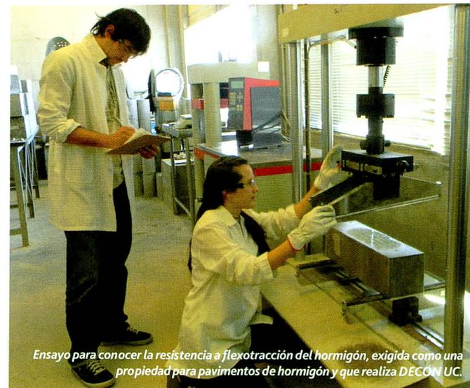
Ensayo para conocer la resistencia a flexotracción del hormigón, exigida como una propiedad para pavimentos de hormigón y que realiza DECON UC.
